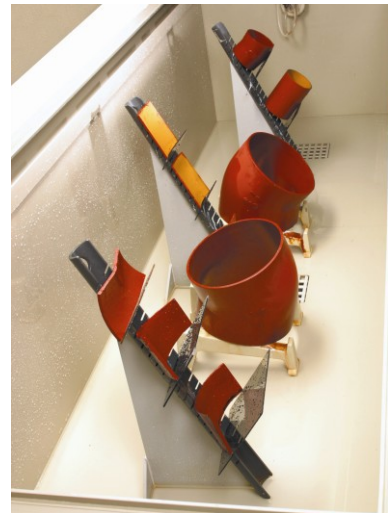
Bild „Salzspühnebeltest 1500 h (MPA NRW Dortmund)“
