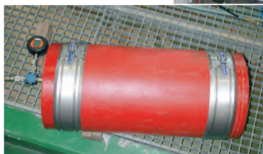
Unterdruckprüfung, Haltezeit 1 Stunde bei Vakuumentwässerung
