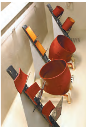
Salzsprühnebeltest 1500 h (MPA Dortmund)
