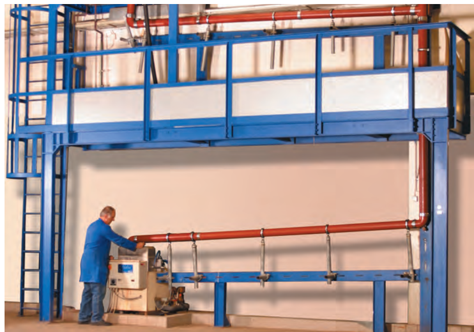
Versuchsaufbau zur Ermittlung der Temperaturwechselbeständigkeit (MPA-Dortmund)
