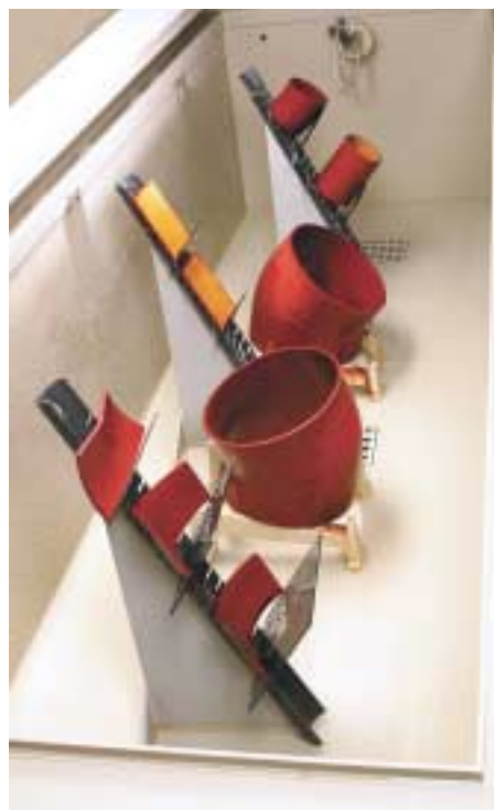
Geöffnete Kammer für den Salzsprühnebeltest mit Rohr- und Formstückproben (MPA-Dortmund).
