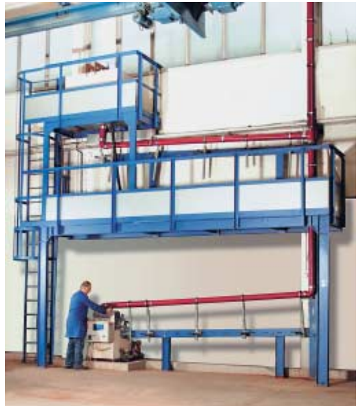
Versuchsaufbau zur Ermittlung der Temperaturwechselbeständigkeit (MPA-Dortmund).
