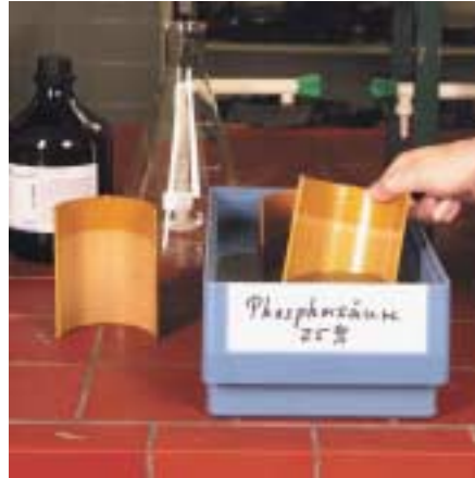
Rohrproben nach bestandener Prüfung in 25%iger Phosphorsäure bei 40°C und einer Prüfdauer von 72 Stunden (MPA-Dortmund).
