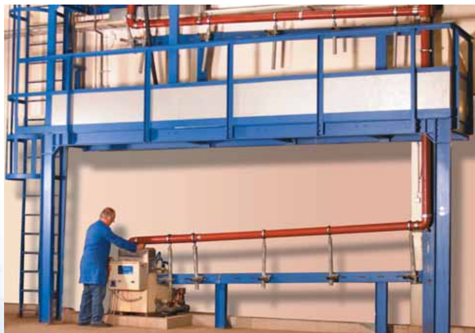
Versuchsaufbau zur Ermittlung der Temperaturwechselbeständigkeit (MPA-Dortmund)
