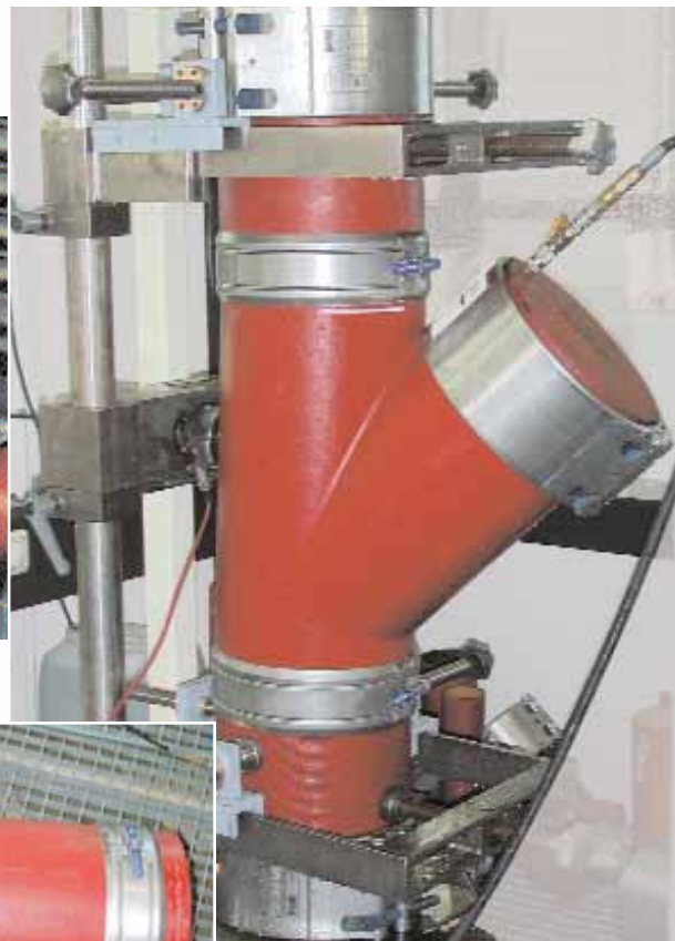
Wasserdichtheitsprüfung unter Innendruck bei Abwinklung und Scherlast als überlagerte Beanspruchungen
