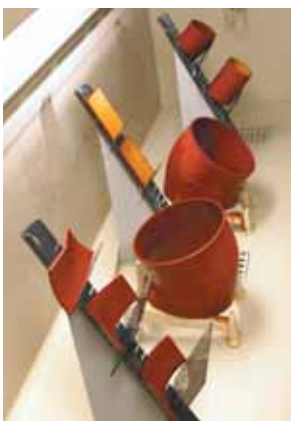
Salzsprühnebeltest 1500 h (MPA Dortmund)
