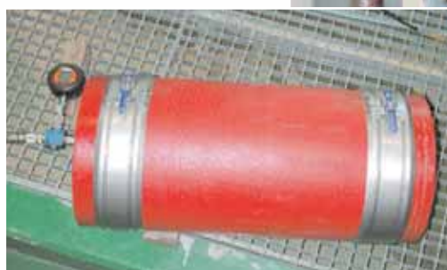
Flammprüfung über 90 Minuten des lose gelagerten Prüfstranges
