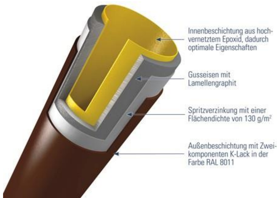
Abbildung Beschichtungsaufbau TML-Rohre (Düker)
