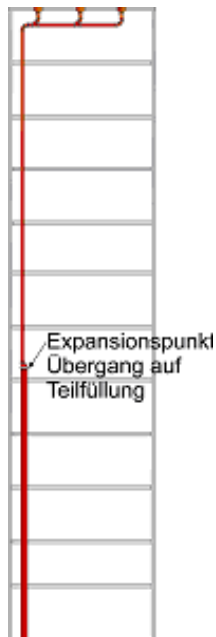
Bild „Eingeschränkte Falleitungshöhe“
